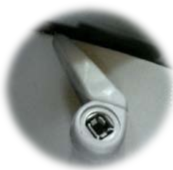
LENDENWIRBELSTÜTZE - HEBEL ABGERISSEN
