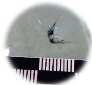
STEINSCHLAG MIT RISSBILDUNG
