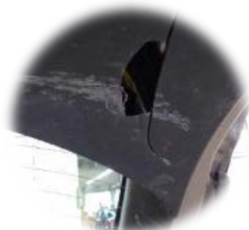
GEBROCHENE VERKLEIDUNG HECKKLAPPE
