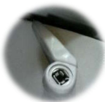
LENDEWIRBELSTÜTZE - HEBEL ABGERISSEN
